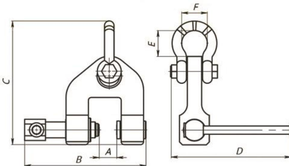
Рис.1 - Габаритные размеры трубчатого захвата
